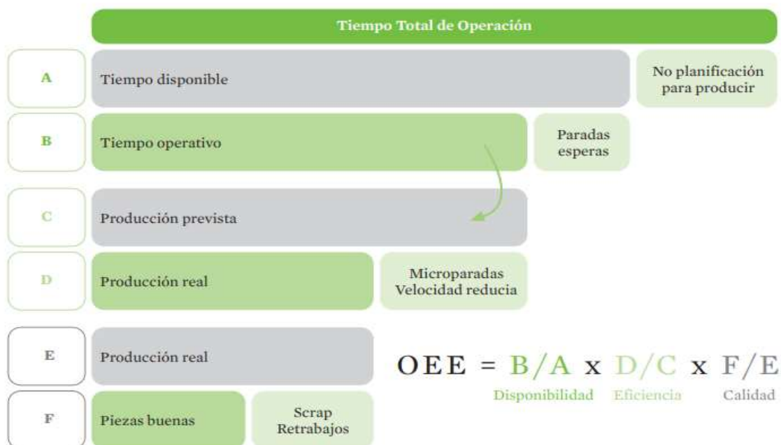
Figura 7 Esquemas de los componentes del OEE
